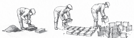
↑ Dès que les briques peuvent être manipulées sans se déformer, elles sont retournées sur la tranche pour sécher de manière homogène sur les deux faces.
