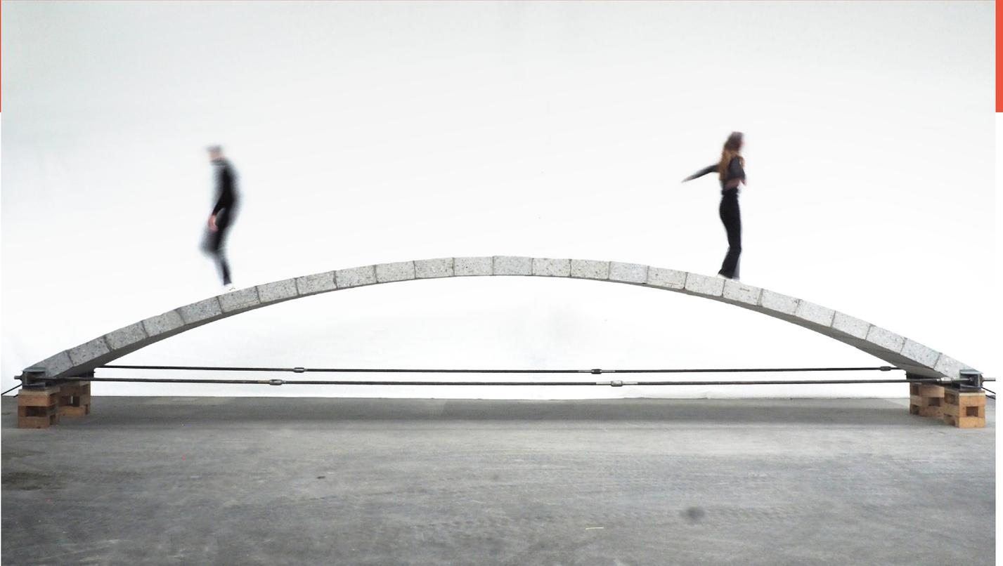
Passerelle en béton de réemploi à partir de murs d'un bâtiment en rénovation
